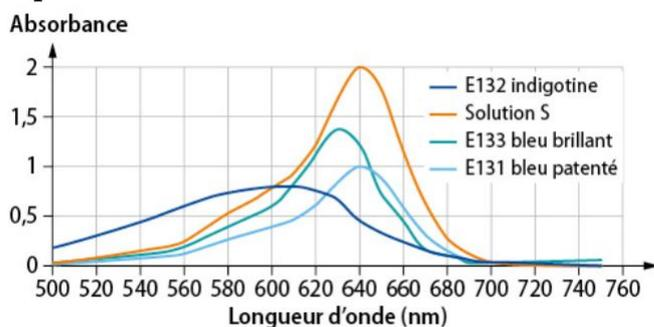
Le maximum d'absorption de la solution S est de 640 nm. Il est identique au maximum d'absorption du colorant bleu patenté (E131). Donc la couleur de la solution S est due à la présence du colorant bleu patenté (E131).
