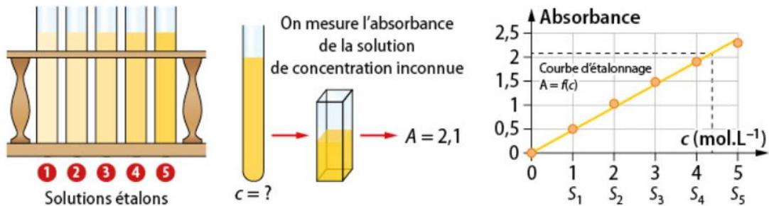
On mesure l'absorbance de la solution inconnue. Puis on détermine la concentration molaire de la solution en colorant par lecture graphique sur la courbe d'étalonnage :  $c = 4,4 \times 10^{-3} \text{ mol.L}^{-1}$
