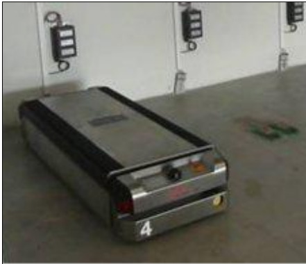
◀ A.G.V. à vide lors de la phase de recharge des batteries
