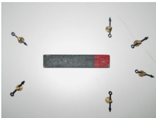
Aiguilles aimantées s'orientant selon le champ magnétique d'un aimant
