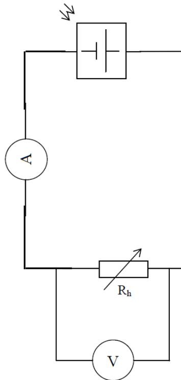
C.2.2 On éclaire le panneau solaire avec une lampe que l'on place à 15 cm du panneau solaire. On modifie la valeur de l'intensité du circuit en utilisant le rhéostat. Et on mesure la valeur de la tension pour les différentes valeurs de l'intensité.
